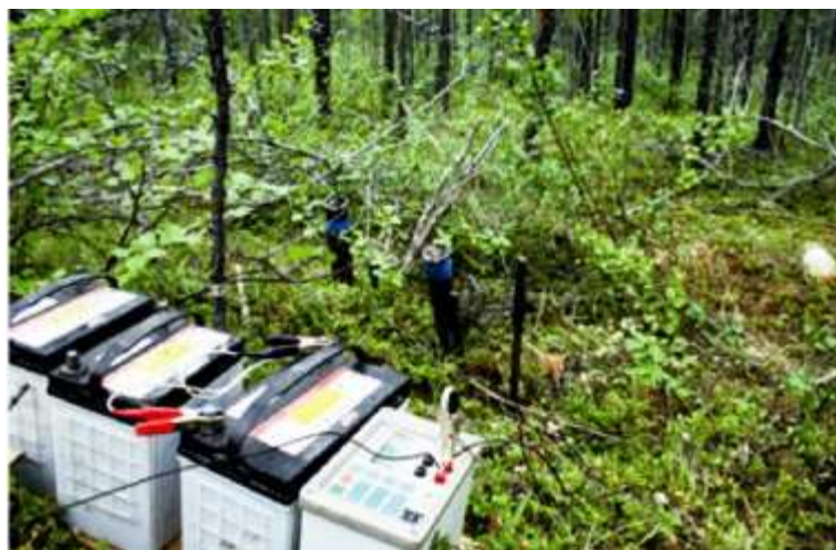
Рис. 2. Внешний вид аппаратуры МЭРИ-24 (а) и АСТРА-100 (б) в полевых условиях
